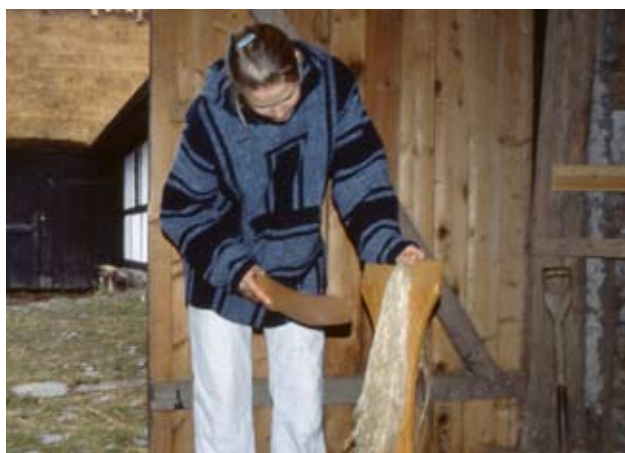
Då linet skäkts drar man skäktniven med bestämda tag längs fibrerna så att skalrester försvinner och strået plattas ut.
