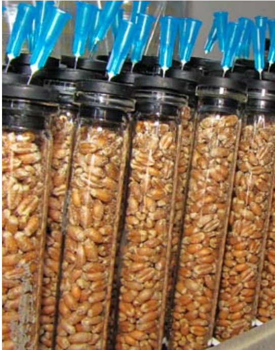
Minisilos" för studier av lagringstabilitet hos spannmål i syrefri miljö. Foto: Mikael Pell
