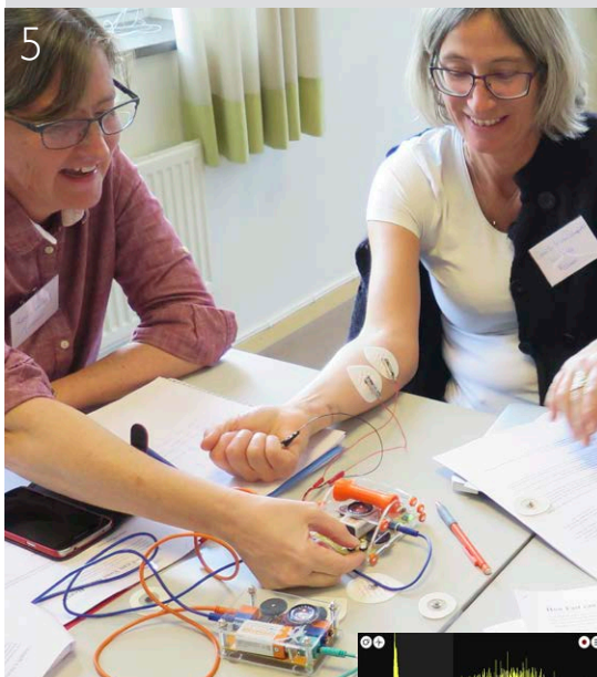
Signalen och muskelkontraktionen registreras och reaktionstiden kan mätas med en noggrannhet av en tusendels sekund.
