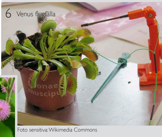
Signalen och muskelkontraktionen registreras och reaktionstiden kan mätas med en noggrannhet av en tusendels sekund.
