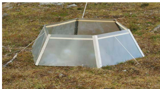
Mini-växthus som används i det internationella tundraexperimentet, ITEX, för att simulera global uppvärmning.
