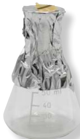
E-kolv täckt med aluminiumfolie. Tejprens av autoklavtejp som får en svart rand då den hettats upp (för sterilisering).
