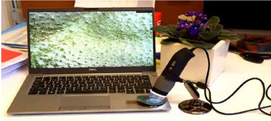
Exempel på USB-kamera som riktats mot ett blad, och bilden syns i den inkopplade datorn.
