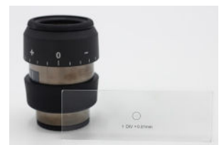
Mätokular och objektglas med mikrometerskala (objektmikrometern)
